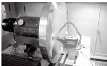
光学クリスタル超大型自由曲面ミラーの加工
